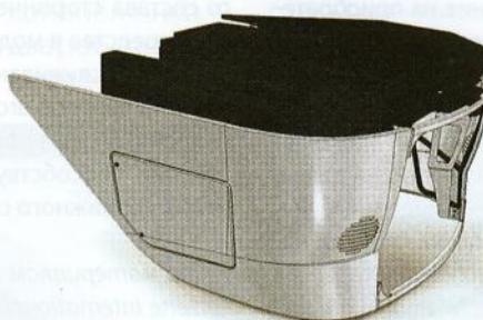
Рис. 2. Алюминиевый обтекатель для дизель-поезда компании «Hyundai Rotem» (Южная Корея)
